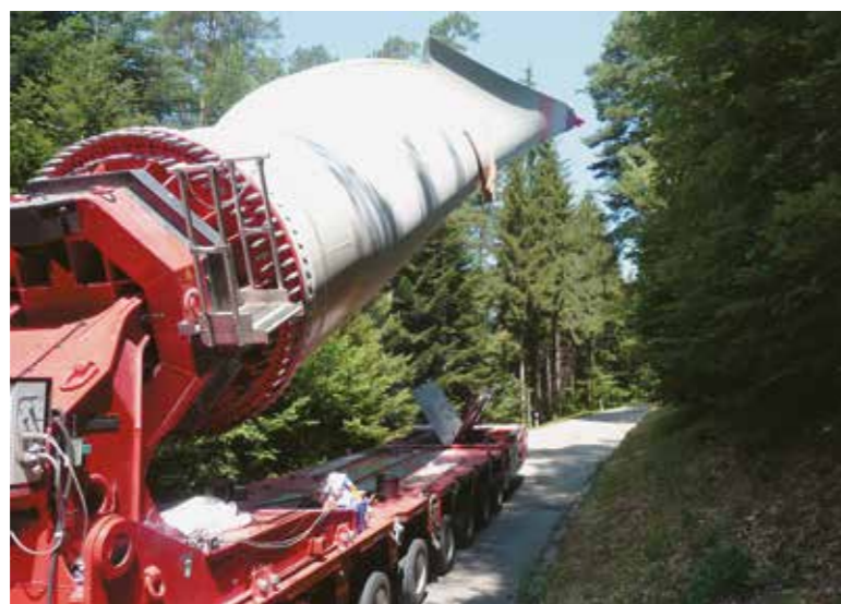
Komponententransport mit Spezialequipment für die E-101 auf der Prechtaler Schanze.
